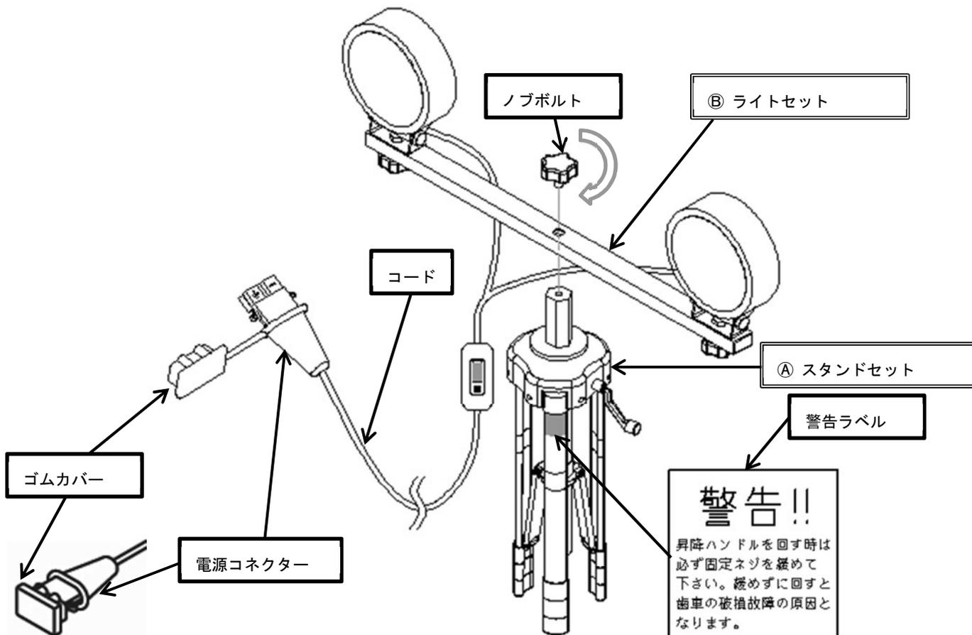
※使用しない時は、電源コネクターにゴムカバーを取り付けて保管してください。
