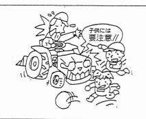
▲ 警告 トラクタと作業機の周辺に人を近づけない トラクタを移動して作業機と着脱するときは、トラクタ の周辺や作業機との間に人が入らないようにしてください。
