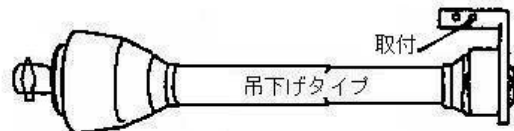
広角側をトラクタ PTO 軸へ
