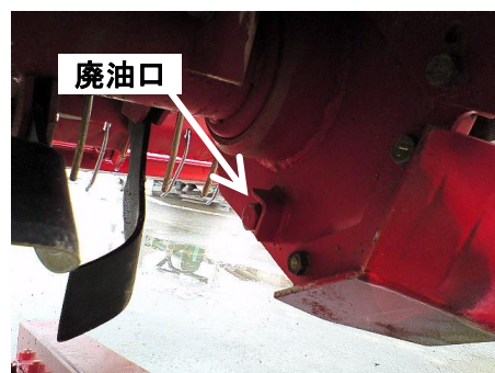
チェーンケース下 (ツメ軸側) M12ボルト
