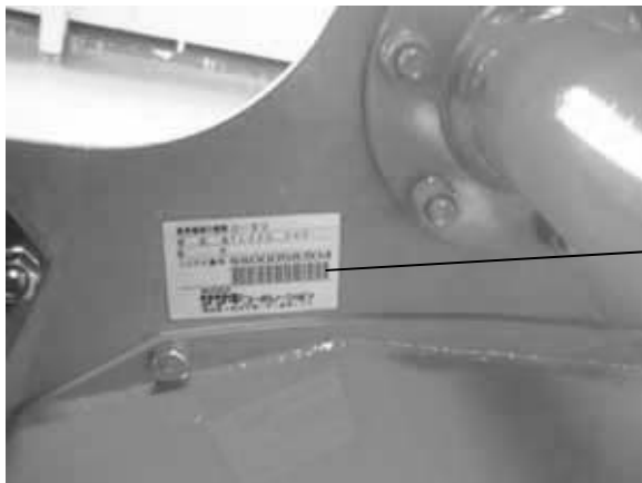
機体銘板貼付位置
