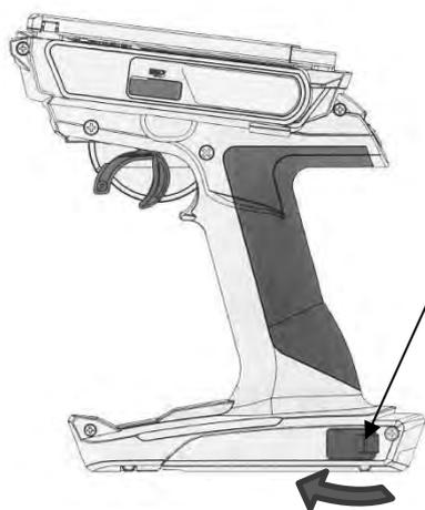
バッテリー充電口カバーの突起に爪をかけ、コントローラ前方向に開いてください
